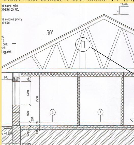
Komín, který se staví u vnější zdi, musí být přikoven pásovou ocelí minimálně po 3 m k nosné zdi, potom natažen lepidlem do perlinky a omítkou. Komín musí stát na základu o rozměru 50x50 cm. Základ jde do nezámrné hloubky. Ta je podle teplotního pásma 80 až 120 cm. Výztuž musí být osazena v rozích tvárnice po celé výšce komínu. Na severní návětrné straně doporučujeme komín zateplit izolací, aby nepromrzal.
